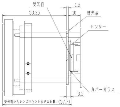
※フランジバック距離 実像を見ながら調整しています。
