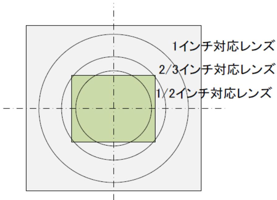
※上図は1/2インチ =  $\phi 8\text{mm}$ 、2/3インチ =  $\phi 11\text{mm}$ 、1インチ =  $\phi 15.8\text{mm}$ にてセンサーの対角と比較していますが、実際の視野範囲はレンズにより異なります。
