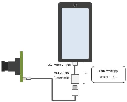
カメラを複数台接続する場合は、USB OTG 対応ケーブルと USB A-B ケーブルで USB HUB と接続し、USB HUB とカメラを付属の USB2.0 ケーブルで接続してください。
