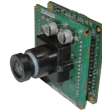
M12 型レンズ付属 ボードカメラ (M12 × P0.5 f=8.8mm ボードレンズ付)
